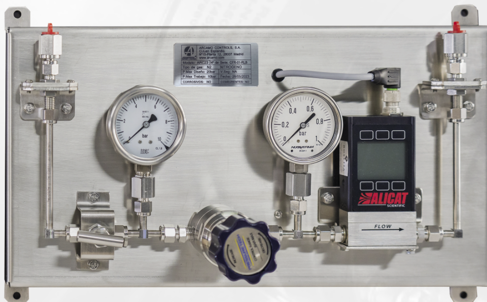
EQUIPO DE N2 PARA EL CONTROL DE FUGAS EN RETENES. N2 EQUIPMENT TO CONTROL SEAL LEAKS.
